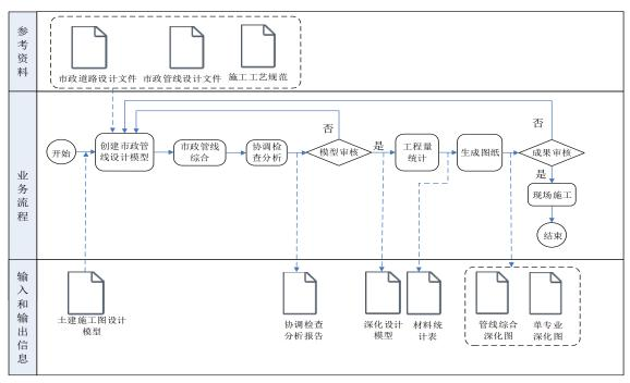
图 5.3-7 市政管线深化设计流程图
