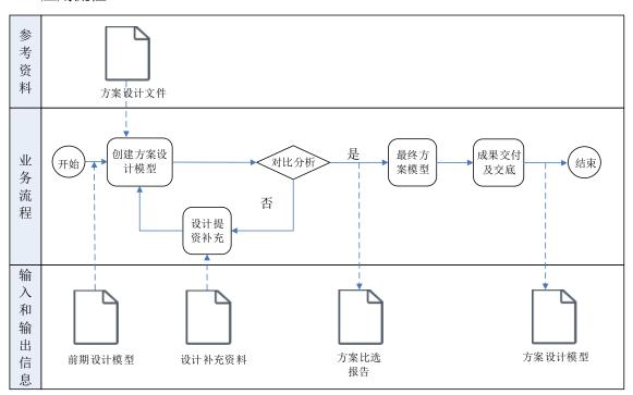
图 5.3-1 规划方案比选 BIM 应用流程图
