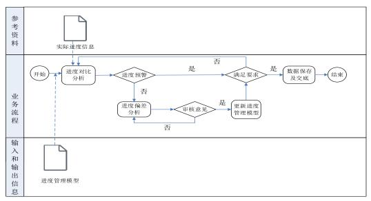
图 5.3.2.11 进度控制流程图
