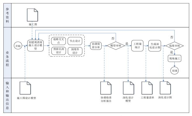
图 5.3-5 深化设计 BIM 应用流程图
