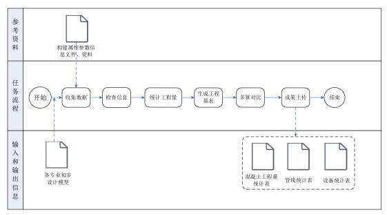
图 5.3-3 工程量统计 BIM 应用流程图
