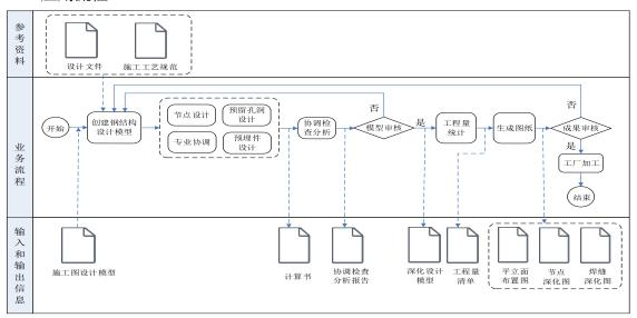
图 5.3-6 装钢结构深化设计流程图
